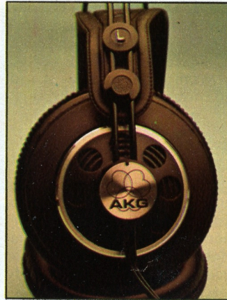
Lo snodo orizzontale è affidato alla flessibilità dell'archetto. Le sei capsule «passive» estendono la risposta alle basse.
